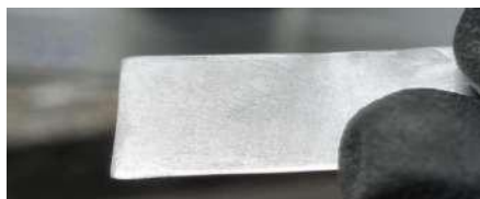
Fig. 1. Placa de Alumínio após polimento mecânico. Autor: Pedro Costa, 2024
